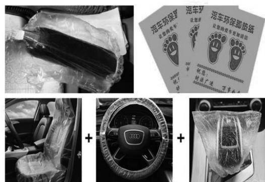
图 1.2 汽车维修防护“五件套”
