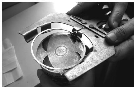
图 1.27 活塞环拆装钳的使用
