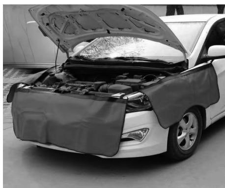
图 1.1 使用翼子板护垫
