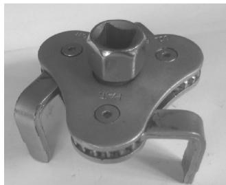
图 1.35 三爪式滤清器扳手
