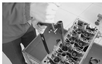
图 1.29 气门弹簧拆装架的使用
