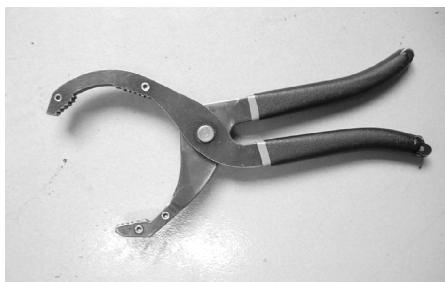
图 1.33 钳式滤清器扳手
